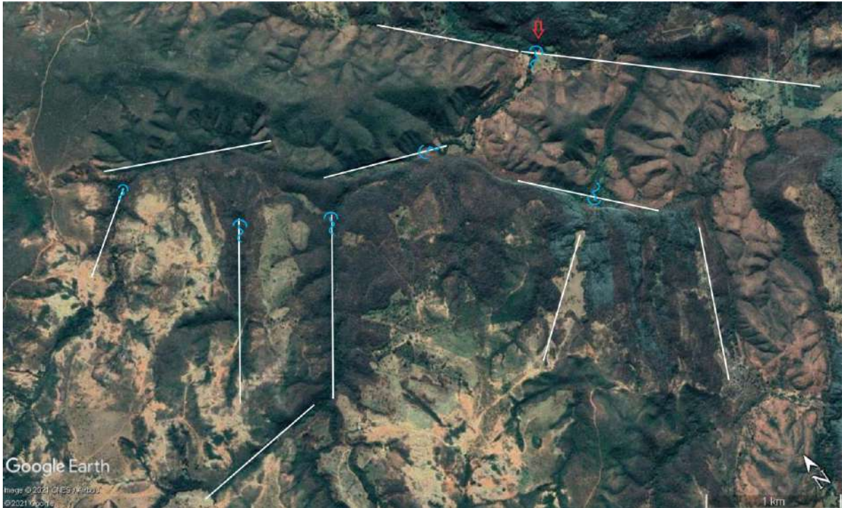
Figura 16: Complexo de sumidouros e ressurgências e controle estrutural sobre os cursos d'água locais determinados por falhas geológicas na região de Santa Rosa de Lima. Destacamos com a seta vermelha o sumidouro do Córrego Patrona, onde se desenvolve a Lapa Encantada. Imagem CNES/Airbus, de julho de 2019.
