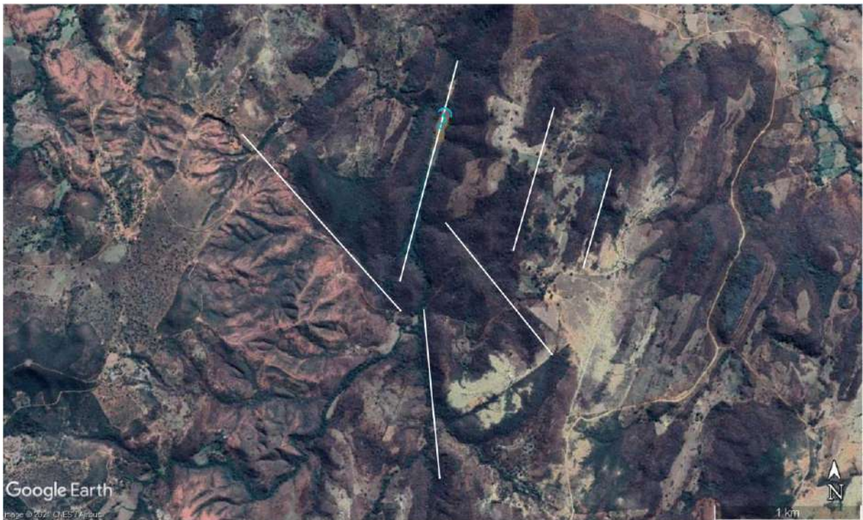
Figura 15: Controle estrutural do Córrego do Campo por falha geológica com sumidouro a jusante em imagem CNES/Airbus, de julho de 2019.
