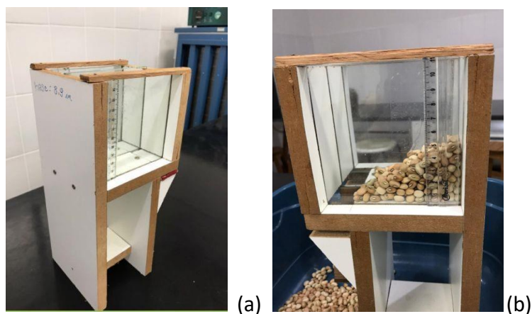
Figura 3. (a) Protótipo utilizado para determinar o ângulo de repouso e (b) grãos formando o talude
