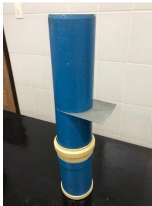
Figura 2. Protótipo utilizado para determinar o peso hectolitro.
