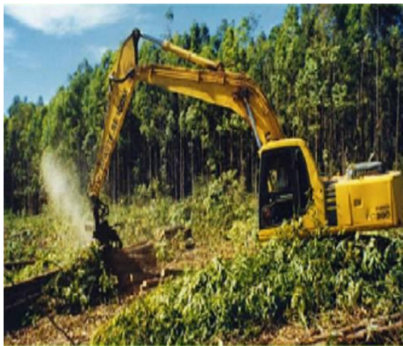
FIGURA 3 – Colheita mecanizada Fonte: V & M Florestal Ltda.
