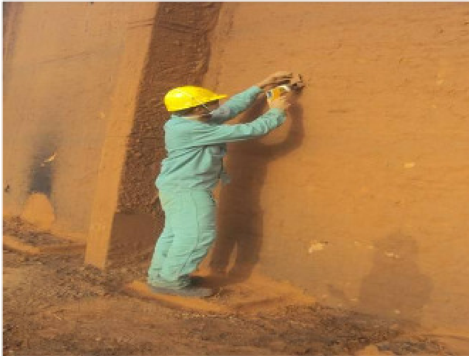
FIGURA 4 – Funcionário da Carvoaria usando software de controle de carbonização num dos fornos da empresa
